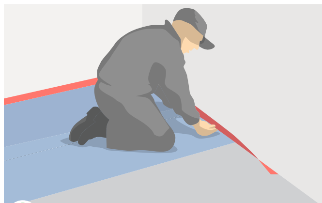
2 Aplicação da barreira perimétrica
