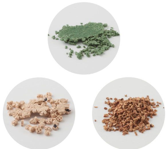
Remplissages EPDM, TPE et au liège après un essai d'1 heure à 65° C et 2N/mm²
