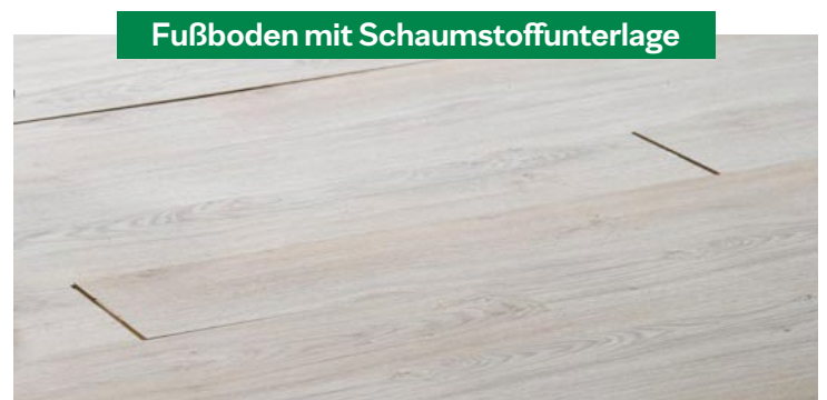
Diese Bilder dienen lediglich der Veranschaulichung und sollen die Verschlechterung des Bodenbelags nach Durchführung der Tests darstellen.
